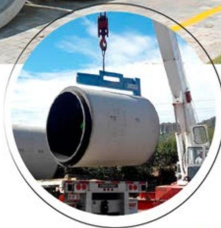
Tubo de concreto reforzado con junta hermética para alcantarillado sanitario y drenaje pluvial., así como tubo con junta de mortero para SCT. Diámetros: 30, 38, 45, 61, 76, 91, 107, 122, 152, 183, 213, 244 y 305 cm.
